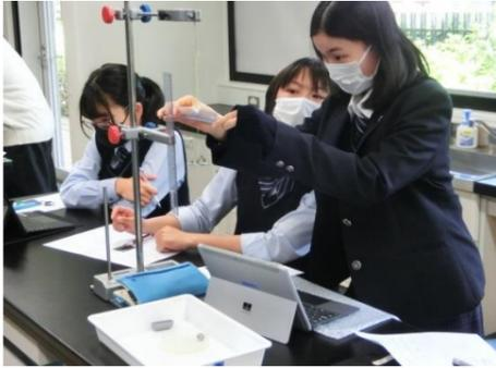
まずは班ごとに異なるばねのばね定数を求めます。中学でも実験しましたが、おもりの質量とばねの長さは比例しましたね。
