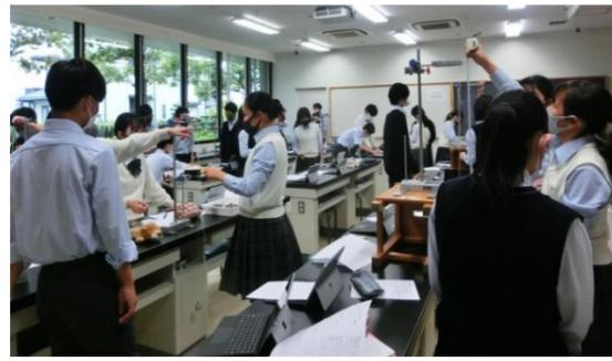
班ごとに振り子の長さ、おもりの重さを変え、10回振動するのにかかる時間測定し周期Tを求めます。
