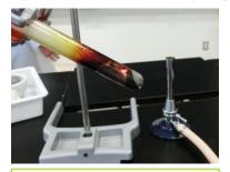
混合粉末を試験管に入れ、上部 を加熱します。マグマ状に反応が 開始したら火を遠ざけ全体が反 応するまで待ちます。
