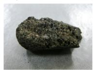
試験管から取り出した反応物 (硫化鉄)です。ごつごつとしてま るで溶岩そのものです。
