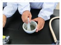
鉄粉と硫黄粉末を量り取り、乳 鉢の中でよくすり混ぜます。 均一に混ぜることが実験成功の 秘訣です。
