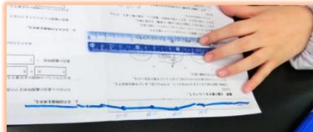
専用の分度器をあて、南中高度(太陽の高さ)を測ります。半球に打った点をつなぐ線をセロハンテープに写し取りました。テープの長さから日の出・日の入り時刻を計算で求めました。
