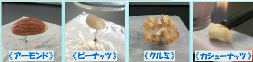
(準備)各選手は質量を量られた後、クリップと段ボール、アルミ箔で作られた加熱台に固定されます。アルミ缶と針金で作ったバケツに水を入れ、温度計と共にスタンドに固定。さあ、準備OKです。
