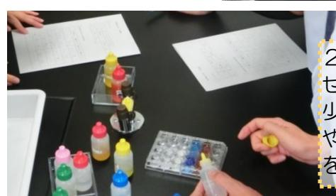
20種の溶液を組み合わせ実験しました。少ない溶液量でも観察しやすいようセルプレートを用いました。
