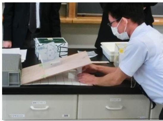
箱の中には、箱が倒れやすくなる工夫がされている。箱が倒れるまで板の下の支持箱を進め、その距離を測定する。
