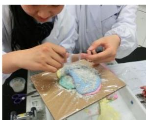
⑧ ストローで、ボーリング操作をしたら、断面と見比べます。
