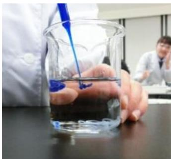
パスツールピペットで希硫酸中に静かに押し出し、しばらく放置して脱色したら、水洗い・乾燥させて完成です。
