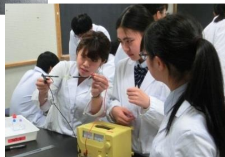
③ 数分間電流を流し、どちら(+)にどれだけ(cm)どんな色に変化したかを確認します。
