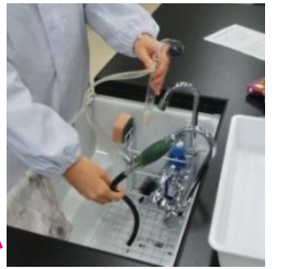
アスピレーターで真空に近づけます。
