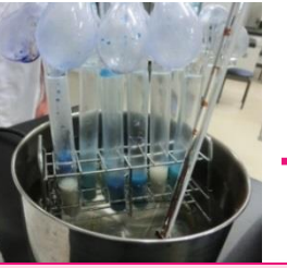
37℃に加温すると激しく反応し、青色が変化します。
