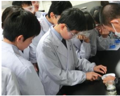
ピンセットとメスを使ってカリウムを切っています。
