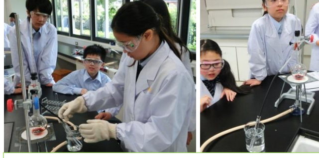
枝付き丸底フラスコから繋がったゴム管を、試験管に通します。試験管は水を入れたビーカーで冷やします。
