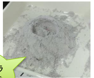
千枚通しを使ってマグマだまりに穴をあける(風船を割る)と、一気に噴出した空気によってカルデラができました。
