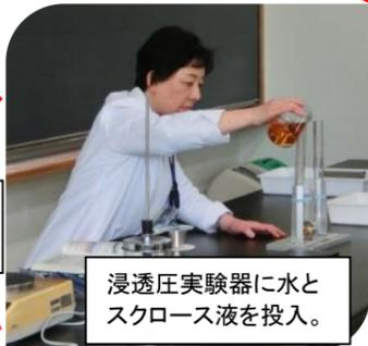
浸透圧実験器に水とスクロース液を投入。
