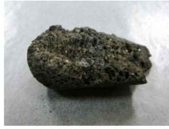
試験管から取り出した反応物(硫化鉄)です。ごっごつとしてまるで溶岩そのものです。
