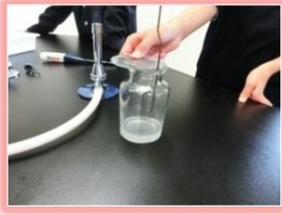
燃焼さじに物質をのせ、ガスバーナーで加熱し、石灰水の入った集気びんに素早く移動させます。やけどの危険もあります。注意して！
