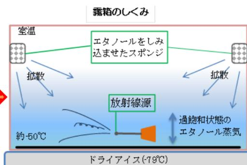
過飽和状態のアルコール蒸気は放射線の通過する刺激によってイオンとなり、それが核となって霧が発生します。雨雲が近くにあるときにできる飛行機雲と似ています。太くはっきり見えるのがα線、細く縮れて見えるのがβ線です。神秘的な現象に、歓声が上がりました。空気中に自然に存在する宇宙線は、放射線源を入れなくとも観察できます。
