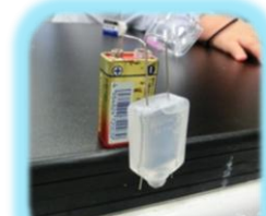
電気分解装置を電池にセットすると徐々に容器内が水素で満たされます
