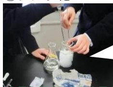
アニリンに亜硝酸ナトリウムと塩酸を反応させて、塩化ベンゼンジアゾニウムを合成する。
