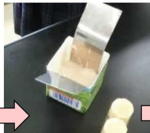
電極板をセットした牛乳パックに生地を流し込みます。
